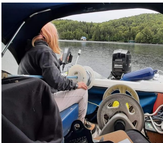
Photo 1: Technologiste de l'environnement effectuant les mesures de température et oxygène dissous du Lac de Écorces, avec l'instrument/sonde de ODe temp
